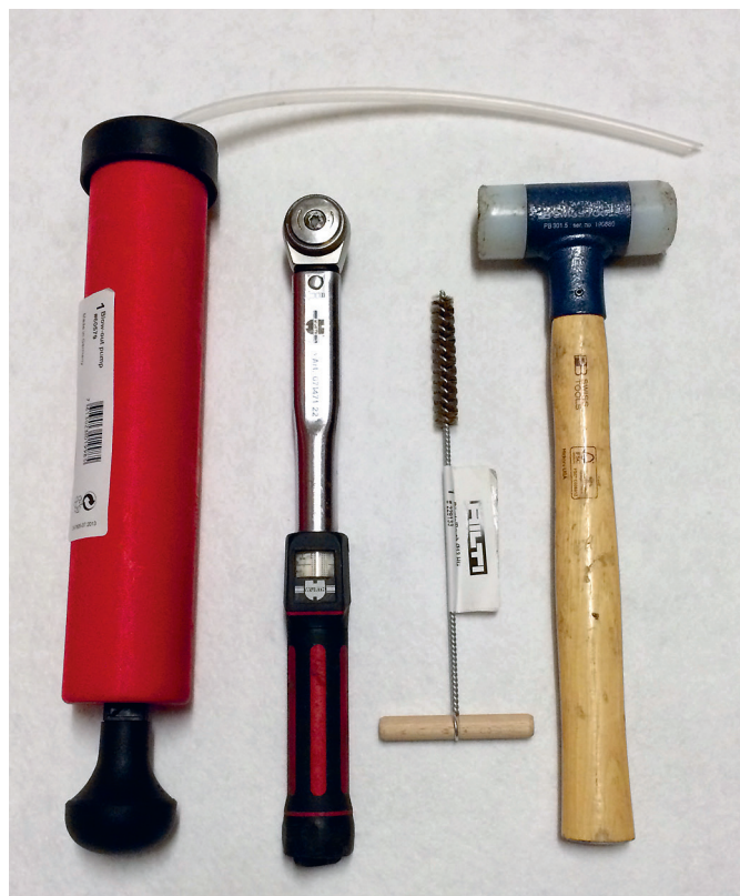
Fig. 22: Assortiment d'outils avec clé dynamométrique, soufflette, etc. pour le montage des points de fixation
